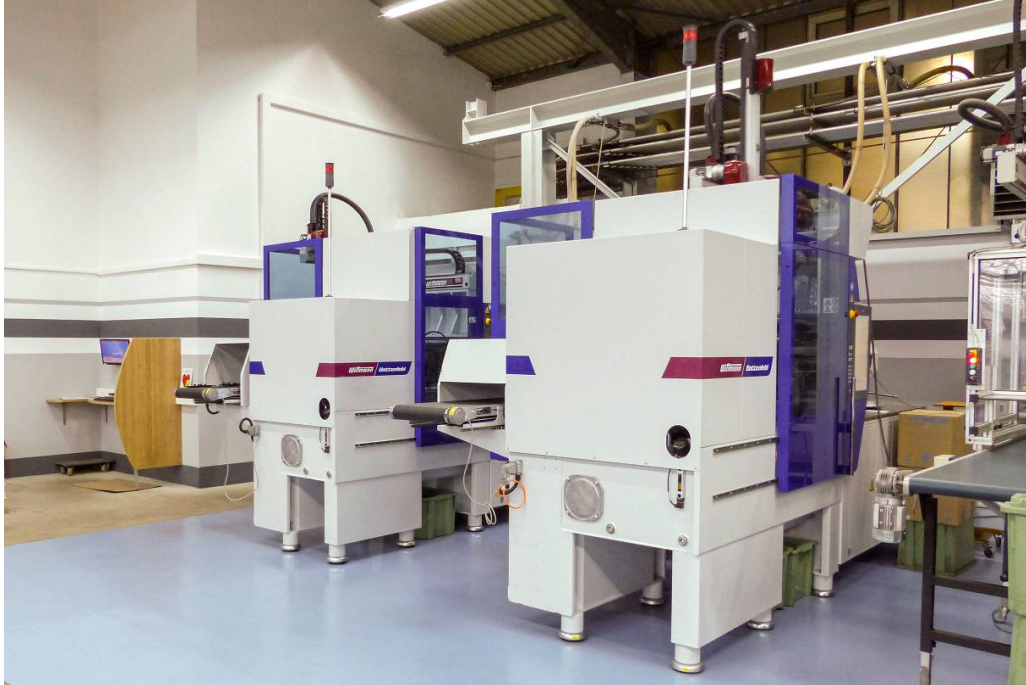
Abb. 1: SmartPower 60 und SmartPower 90, als Insider-Zellen ausgeführt. (Foto: WITTMANN BATTENFELD)
